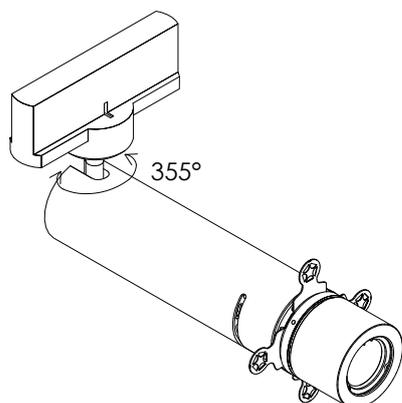
Corpo in alluminio tagliato laser,  $\varnothing$  42mm e L 188mm, verniciato colori opachi bianco RAL 9010 o nero RAL 9005 (a richiesta altri RAL), su staffa orientabile  $\pm 95^\circ$  sull'asse orizzontale e  $355^\circ$  sull'asse verticale, attrezzata con adattatore per binario monofase/trifase e snodo con blocco regolabile a frizione. Apparecchio dotato di lamelle regolabili per sagomare in modo netto la luce, la messa a fuoco è manuale rotativa.
